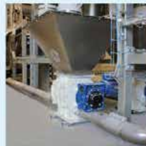
Sas alvéolaires à passage tangentiel
