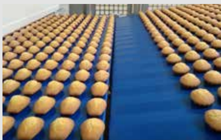
→ Les bandes transporteuses pour l'agroalimentaire sont créées pour éliminer le problème de contamination ou d'effilochage.
