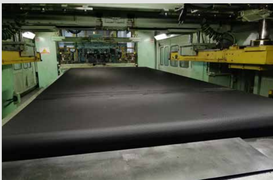
→ Maas propose des bandes transporteuses adaptées au convoyage horizontal sur sol de glisse comme sur cette photo. C'est l'un des plus répandus dans l'industrie, car il apporte une surface plane et rigide.
